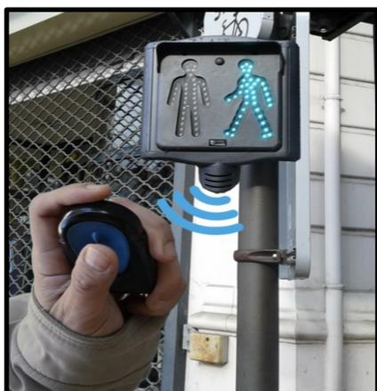
Dispositif de feu sonore sur un feu piéton connecté à une télécommande pour le déclencher
